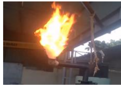
Hình 7. Hình ảnh ngọn lửa 30 kg mùn cưa/h; 12,36 m 3 /h
