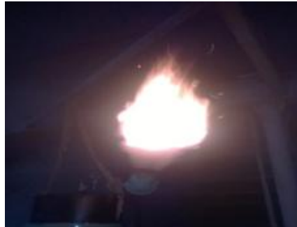
Hình 8. Hình ảnh ngọn lửa 40 kg mùn cưa/h; 12,36 m 3 /h
